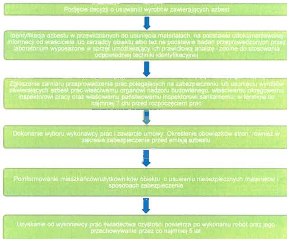
Rysunek 4. Schemat procedury dotyczącej obowiązków i postępowania właścicieli i zarządców przy usuwaniu wyrobów zawierających azbest z obiektów i terenów zlokalizowanych na terenie Gminy Jedlicze.
